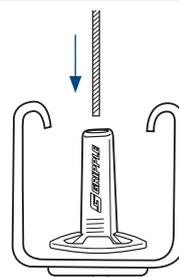
*Paso 3: Introduzca el cable a través del trapezio y ajuste la altura*
