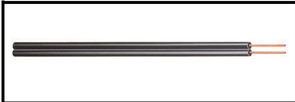
CONSTRUCCION: 2 CONDUCTORES DE ALAMBRE DE ACERO CON RECUBRIMIENTO DE COBRE, AISLAMIENTO EN PARALELO CON PVC NEGRO, FRANJA DE PVC AMARILLA EXTRUIDA PARA POLARIDAD
